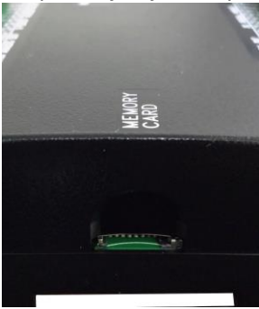
Rysunek 8.1 – Slot kart pamięci MicroSD
